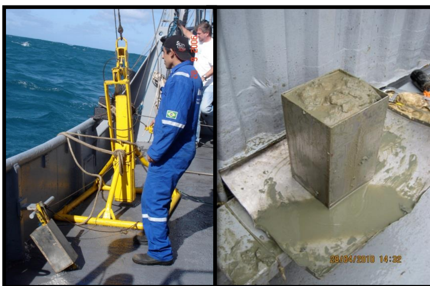
Figura 10: Na esquerda - Amostrador box-corer utilizado na coleta dos testemunhos em abril de 2010, a bordo do navio Av.Pq.Oc. Diadorim. Na direita – Imagem do box-core coletado na plataforma continental de Cabo Frio.
